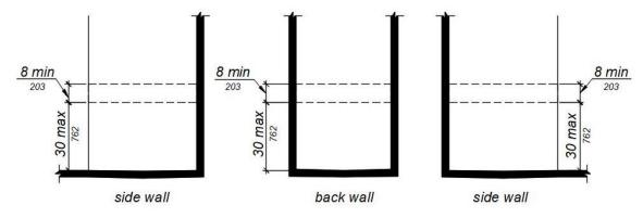
FIGURE 11B-809.10.6.4 REINFORCEMENT FOR GRAB BARS.
